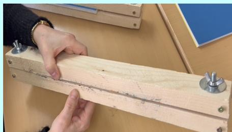
5. Holzpressen, selbst gebaut aus 2 Dachlatten à 50 cm, 2 Löchern für große Flügelschrauben und 4 kleine Schrauben als "Füßchen".
